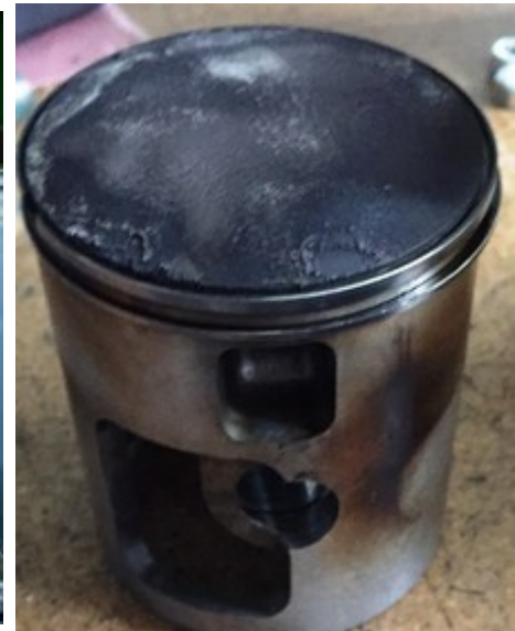
Bild links, Werkstatt-Test, Resultat ok, Bild Mitte, 4 Stück „pissen“, Bild rechts, die Folgen Kolbenbrand
