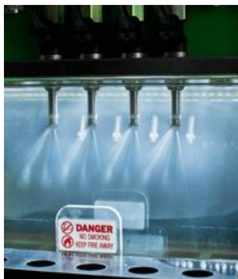
Bild links, Werkstatt-Test, Resultat ok, Bild Mitte, 4 Stück „pissen“, Bild rechts, die Folgen Kolbenbrand
