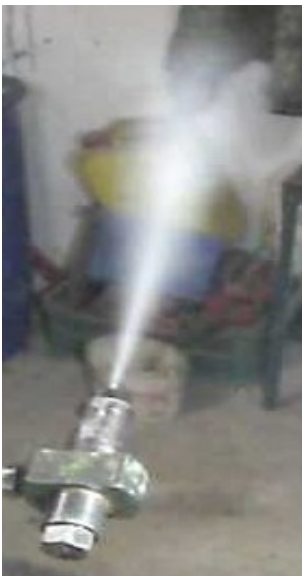
Bild links, Werkstatt-Test, Resultat ok, Bild Mitte, 4 Stück „pissen“, Bild rechts, die Folgen Kolbenbrand
